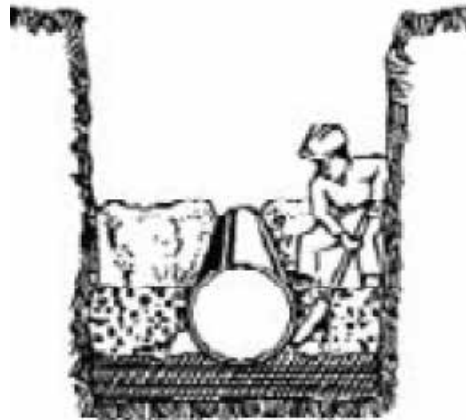
Elimine los huecos que hay debajo de la tubería
